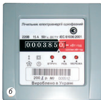
Рис. 33.1. Снятие показаний счетчика: а — первоначальные данные (382 кВт·ч); б — данные счетчика после некоторого времени работы электрообогревателя (385 кВт·ч). Количество использованной за это время электроэнергии: 385 - 382 = 3 \text{ (кВт} \cdot \text{ч)}
