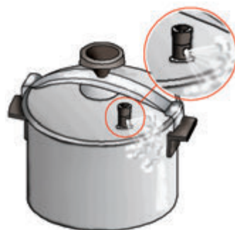
Рис. 14.5. Кастрюля-скороварка: благодаря клапанам и герметичной крышке поддерживается высокое давление в пространстве над жидкостью, поэтому температура кипения воды в такой кастрюле около 120\text{ }^{\circ}\text{C}
