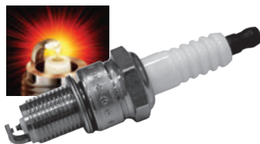
Рис. 40.2. Электрическое напряжение между электродами свечи зажигания составляет 12–15 тыс. вольт
