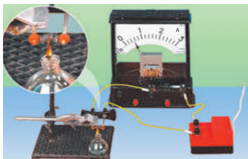
Рис. 36.3. Опыт, демонстрирующий зависимость сопротивления металлов от температуры. Во время нагревания спирали сила тока в ней уменьшается, следовательно, сопротивление спирали возрастает
