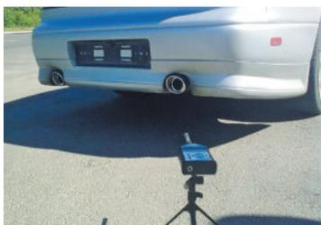
**Рис. 5.** Измерение уровня шума от глушителя автомобиля
