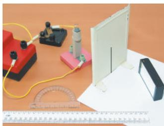
**Тема.** Исследование отражения света с помощью плоского зеркала.
