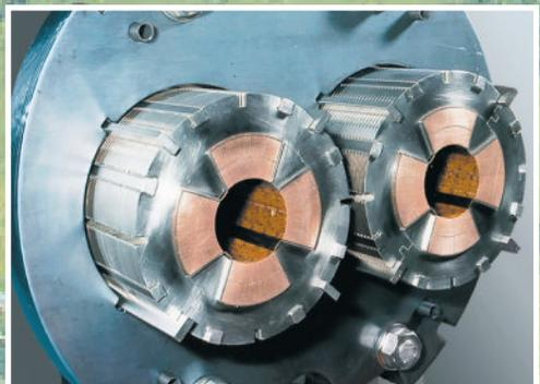
**Рис. 2.** Сверхмощные магниты, удерживающие заряженные частицы внутри ускорителя
