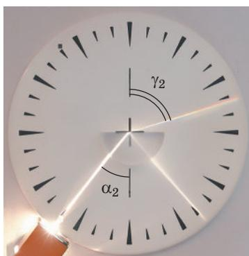
**Рис. 12.5.** Если свет попадает из стекла в воздух, то при увеличении угла падения угол преломления приближается к  $90^\circ$ , а яркость преломленного пучка уменьшается
