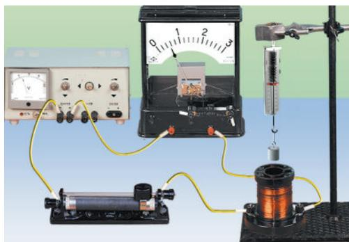
Рис. 6.1. Исследование магнитного действия катушки с током
