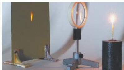
Рис. 15.1. Получение изображения пламени свечи с помощью собирающей линзы
