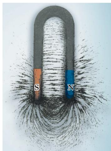
Рис. 2.4. Цепочки железных опилок воспроизводят картину линий магнитной индукции магнитного поля подковообразного магнита
