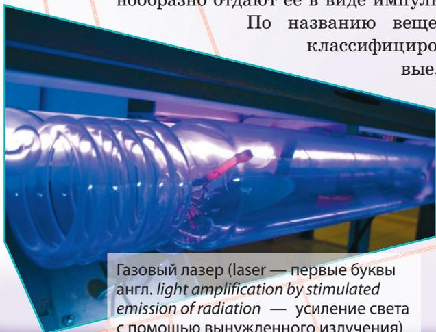
Газовый лазер (laser — первые буквы англ. *light amplification by stimulated emission of radiation* — усиление света с помощью вынужденного излучения)
