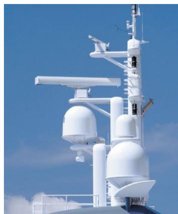
**Рис. 21.5.** Радар современного морского судна
