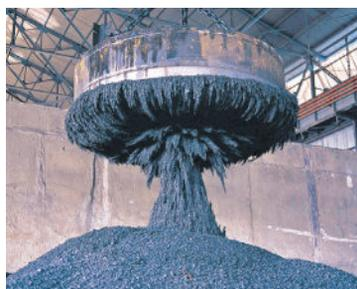
**Рис. 6.5.** Электромагнитный подъемный кран
