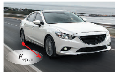
Рис. 13.5. Шины автомобиля в момент соприкосновения с поверхностью дороги по сути пытаются осуществить движение назад. В результате возникает сила трения покоя, направленная вперед, — движущая сила
