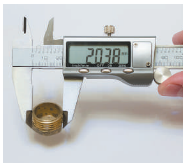
Рис. 2.3. Штангенциркуль. Точность измерения изображенным прибором — сотые доли миллиметра
