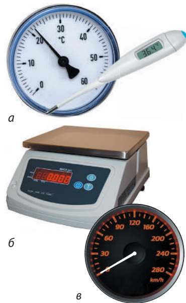
Рис. 2.2. Современные приборы для прямого измерения температуры (а); массы (б); скорости движения (в)
