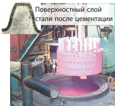
Рис. 27.4. Цементация — процесс насыщения поверхностного слоя стали углеродом. Если изготовить деталь из низкоуглеродистой стали, а затем поместить ее в высокотемпературную смесь, содержащую углерод, то благодаря диффузии поверхностный слой стали обогатится углеродом. Полученная деталь одновременно будет твердой (снаружи — крепкий чугун) и не будет разрушаться при ударных нагрузках (внутри — упругая сталь)
