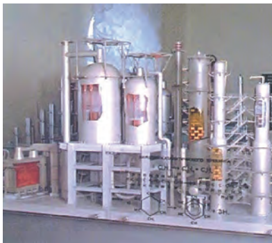
Рис. 29.3. Модель установки для крекинга нефти
