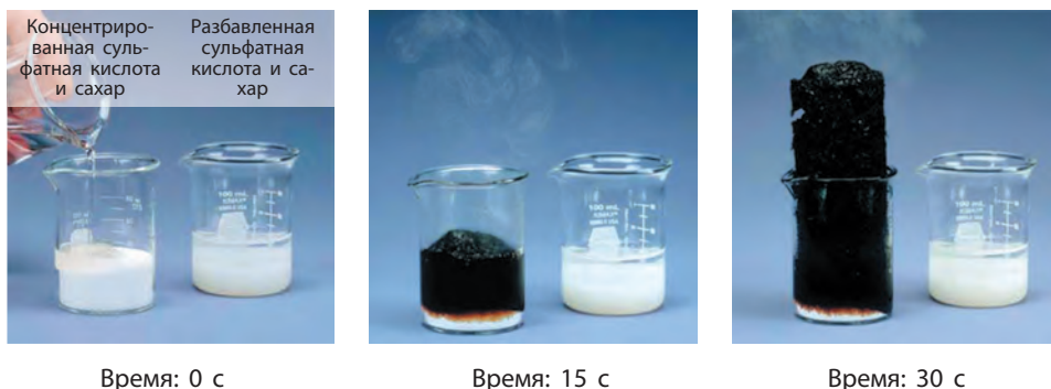
Рис. 36.1. Под действием концентрированной сульфатной кислоты углеводы разлагаются на углерод и воду
