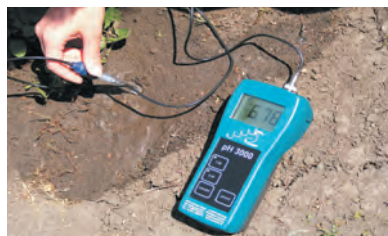
Рис. 11.7. Измерение pH почвы
