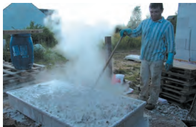
Рис. 18.1. Гашение негашеной извести водой сопровождается выделением большого количества теплоты
