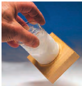
Рис. 18.2. Взаимодействие барий гидроксида с аммоний нитратом
