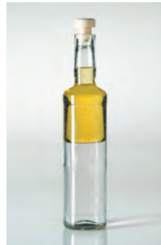
Рис. 6.2. Эмульсия в воде нестойкая: после встряхивания (а) через определенное время жидкости расслаиваются (б)
