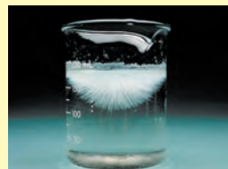
Кристаллизация пересыщенного раствора
