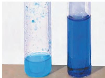
Рис. 32.1. Свежеосажденный купрум(II) гидроксид (слева) и после добавления глицерола (справа)
