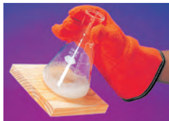
Рис. 4.5. Поглощение теплоты при растворении
