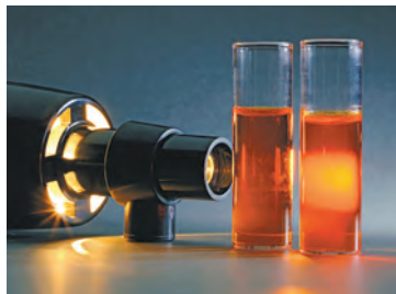
Рис. 3.7. Эффект Тиндаля: при пропускании света через истинный раствор луч не рассеивается, в отличие от прохождения сквозь коллоидный раствор
