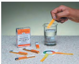
Рис. 11.3. Универсальным индикатором определяют приблизительное значение pH
