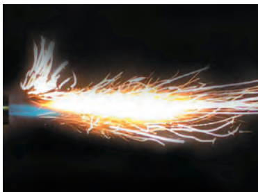
Рис. 20.4. Горение порошка алюминия
