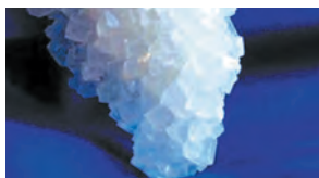
натрий карбонат декагидрат \text{Na}_2\text{CO}_3 \cdot 10\text{H}_2\text{O} — кристаллическая сода
