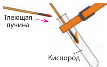
Рис. 20.2. Тлеющая лучина при внесении в чистый кислород вспыхивает
