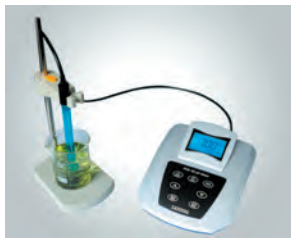
Рис. 11.4. Для измерения pH растворов используют специальные приборы — pH-метры: a — лабораторный (стационарный); б — портативный
