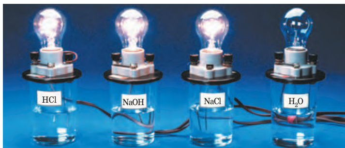
Рис. 8.1. Растворы кислоты, щелочи и соли проводят электрический ток, а чистая вода — нет
