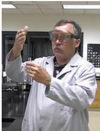
Рис. 24. Как правильно проверять запах реактива
