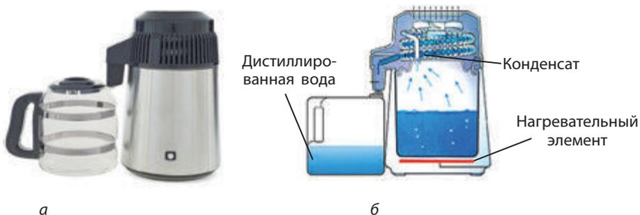
**Рис. 118.** Дистиллятор — устройство для полной очистки воды: а — внешний вид; б — внутреннее строение. Он представляет собой бак с нагревательным прибором. Вода в баке постоянно кипит, а водяной пар конденсируется в специальной емкости — приемнике
