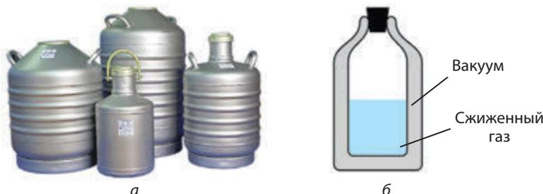
**Рис. 95.** Сосуд Дьюара для хранения сжиженных газов (а) и его строение (б)
