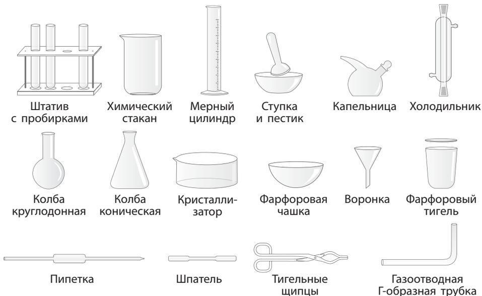
**Рис. 15.** Химическая посуда и другое лабораторное оборудование
