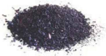
**Рис. 92.** Калий перманганат используют для получения кислорода в лаборатории
