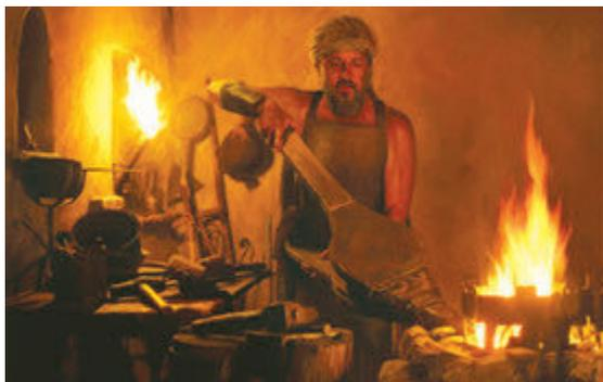
**Рис. 106.** Мех для нагнетания воздуха в пламя для повышения его температуры
