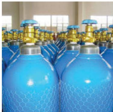
**Рис. 97.** Баллоны для хранения чистого кислорода под высоким давлением
