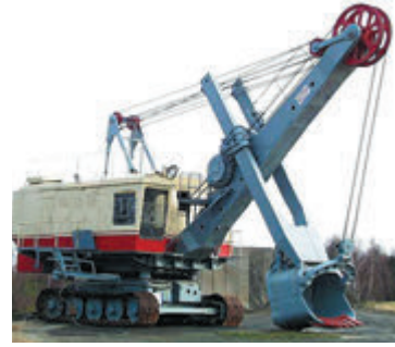
Рис. 35.2. Неподвижные блоки в конструкции карьерных экскаваторов позволяют изменять направление действия сил под любым углом
