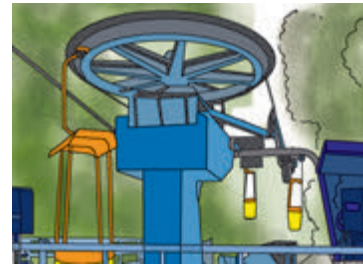
Рис. 35.3. Неподвижный блок в механизме канатной дороги изменяет направление действия силы натяжения каната (а значит, направление движения каната) на противоположное
