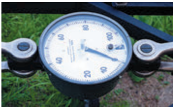
Рис. 19.11. Тяговый динамометр, предназначенный для измерения больших сил, например силы тяги трактора
