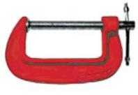
Верхня й нижня губки є єдиною суцільнолитою конструкцією. На нижній губці встановлений підтискний гвинт. Основною перевагою таких струбцин є відсутність люфтів губок, а недоліком — малий діапазон з’єднувальних матеріалів.
