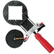
Складаються з металевої (або із синтетичних матеріалів) стрічки та підтискного гвинта, який натягує стрічку. Використовуються для складання та склеювання овальних, круглих і багатокутних конструкцій.
