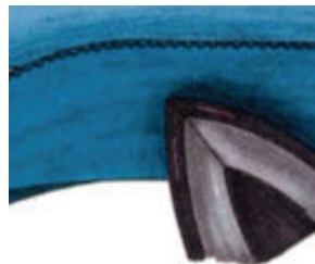
Мал. 12.6. Обробка нижнього зрізу за допомогою клейового матеріалу
