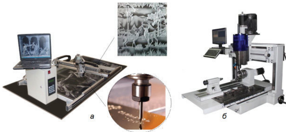
Мал. 9.1. Фрезерно-гравірувальна машина із ЧПУ: а — для площинної обробки; б — для об'ємної обробки
