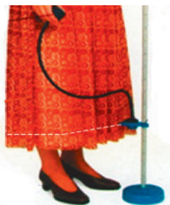
Мал. 12.3. Визначення довжини спідниці за допомогою розміточної стійки
