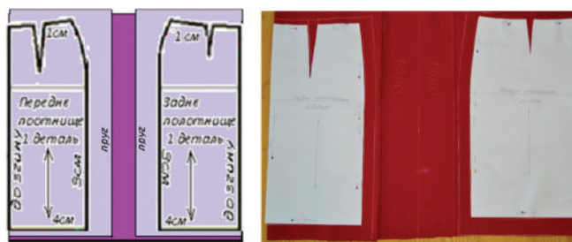
Мал. 6.9. Розкладка викрійки прямої спідниці на тканині завширшки 140 см без шва на задньому та передньому полотнищах
