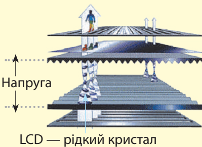
Рис. 3.13. Будова рідкокристалічного монітору
