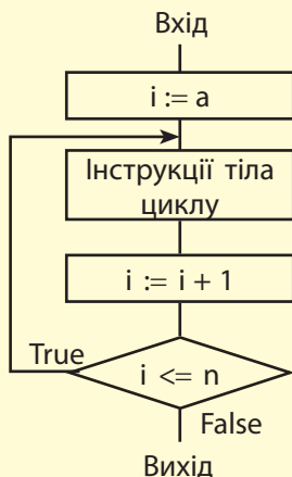
Рис. 13.1. Блок-схема циклу з параметром
